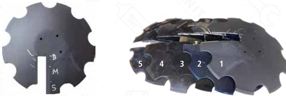
Abbildung 2: Prüfbereich und entnommene Proben an den zu prüfenden Tellerscheiben.
